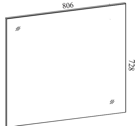
Габаритные размеры: длина - **806** мм, высота - **728** мм, глубина - **20** мм.
