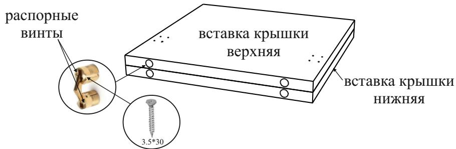
Расположить крышки и вставки крышек как показано на рисунке. Шканты металлические “мама-папа” забиваются в торцы крышек и вставок крышек. В одну крышку забиваются шканты “папа”, в другую - “мама”. Во вставки крышек с одной стороны забиваются шканты “папа”, с другой - “мама” (см. рисунок).
