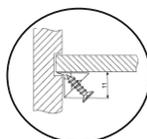
Схема крепления держателя задней стенки
